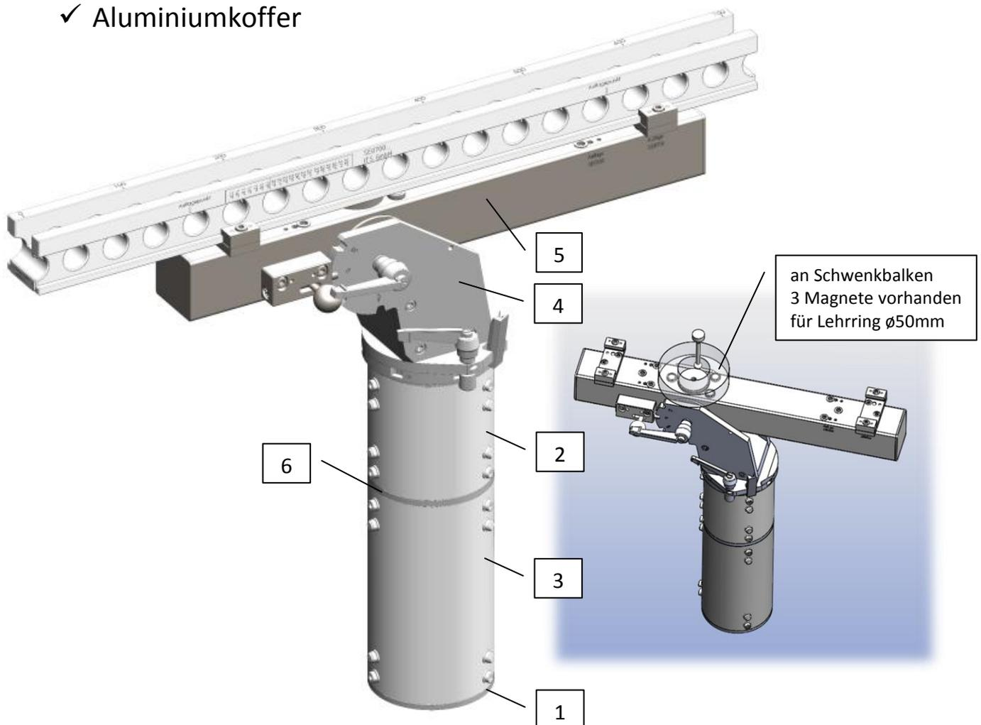
(Halter dargestellt mit Stufenendmaß SE 0700 + Verlängerung 999999-0267-000 + 999999-0269-000+Verbindungsring)
