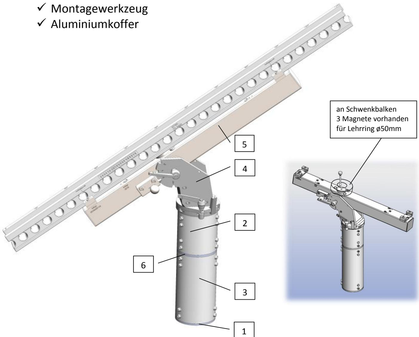
(Halter dargestellt mit Stufenendmaß SE 1100 + Verlängerung 999999-0267-000 + 999999-0269-000 + Verbindungsring)
